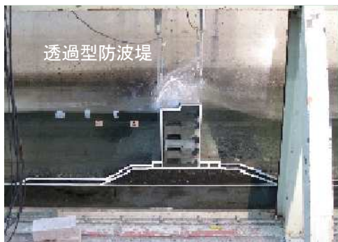
【伝達波実験状況（断面実験）】
