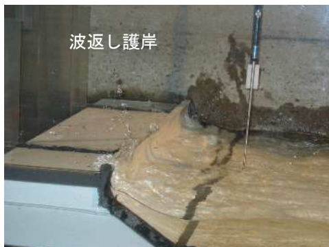
【越波実験状況（断面実験）】
