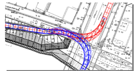
【軌跡図による車両進入確認】
